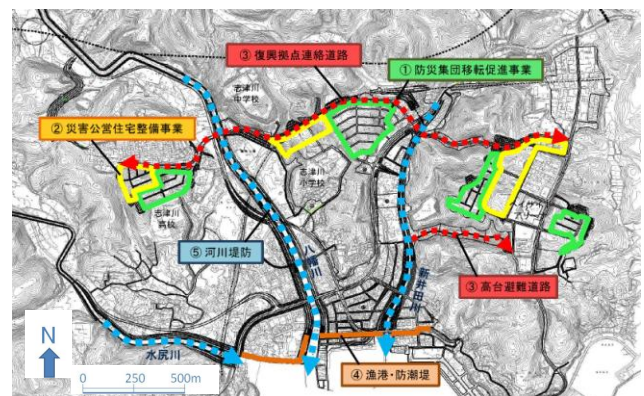
図-5 南三陸町の復興事業区域（盛土をする復興土地区画整理を除き、面的整備は図-4に示す災害危険区域外の高台で実施している。）
