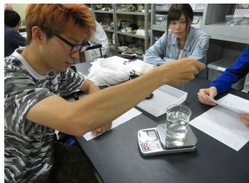
図 3 岩石と鉄の密度測定実習
