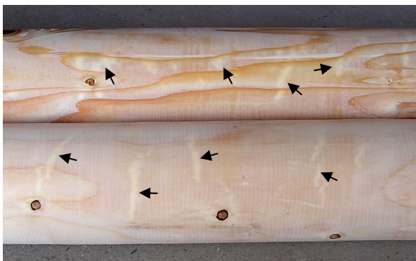
写真1 丸棒加工直後の表面に認められた白色斑(矢印) (上：スギ、下：ヒノキ、直径 10cm)
