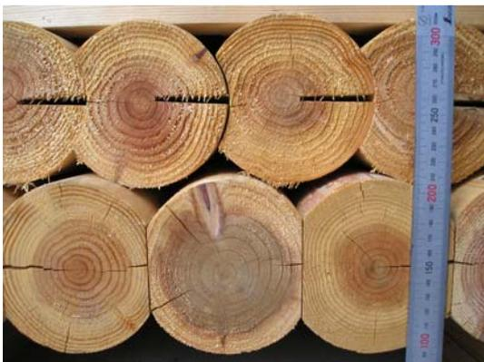
写真2 遮音壁断面（上：ホゾ型、下：タイコ型）
