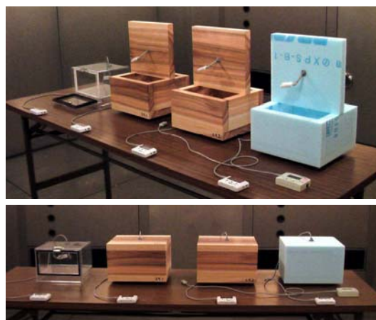
写真4 試験II.4風景 左からデシケータ、スギ1、スギ2、スタイロフォーム。
