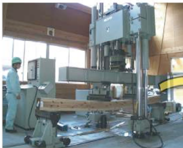
実際に曲げてヤング係数を測定
