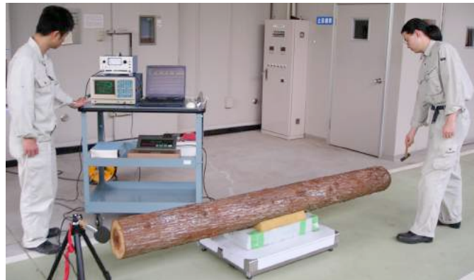
写真 3.1 丸太の動的ヤング係数の測定
