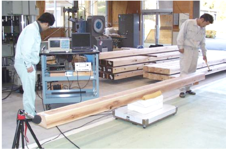
写真 1.1 縦振動法による動的ヤング係数の測定
