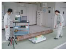
「寸法・重さ・音」からヤング係数を測定
