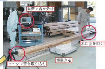
「寸法・重さ・音」からヤング係数を測定
