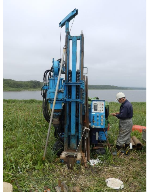
図5. 無水式土壌・地下水調査機エコプローブ(EP-26型)による掘削の様子 (生花苗沼)。
