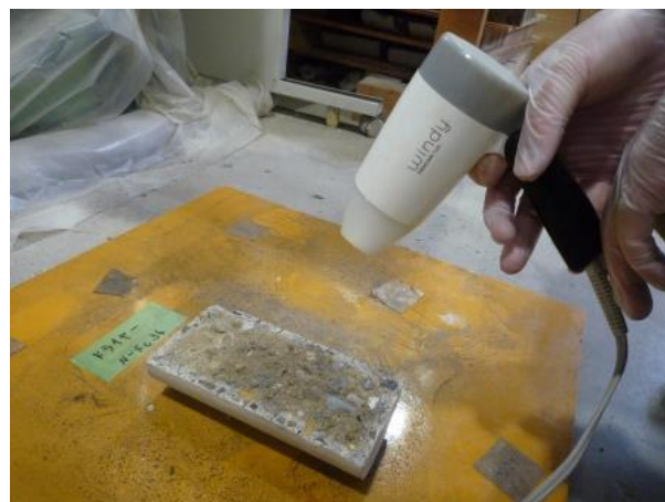
写真-7 ドライヤーにより1分間乾燥(BB-Fc36)
