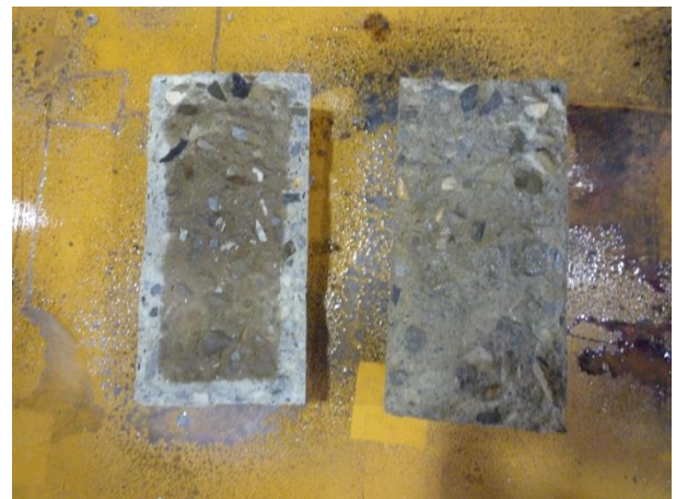
硝酸銀溶液噴霧 水酸化ナトリウム溶液噴霧
