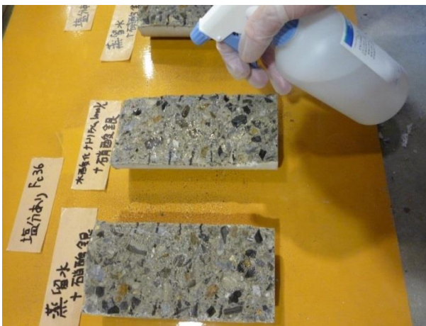
写真-3 水酸化ナトリウム溶液噴霧の様子
