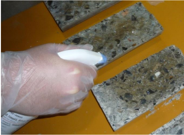
写真-1 硝酸銀溶液噴霧の様子
