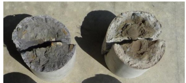
塩化物イオンによる境界 中性化による境界 写真-12 日光による紫外線照射
