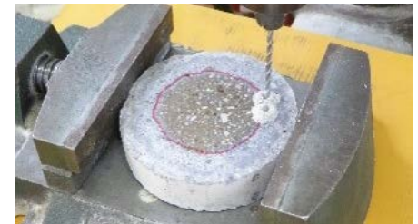
図-4 境界上を削孔している様子
