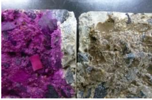
図-5 中性化促進試験後の断面へフェノールフタレイン溶液(左)と硝酸銀溶液(右)を噴霧した結果
