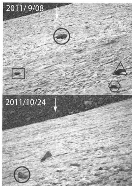
図 1 御前沢雪渓下流部の流動観測用ポールの定点撮影画像 (2011 年 9 月 8 日と 10 月 24 日)。矢印がポール頂部の位置を示す。9 月 8 日にポールの横にあった円で囲った礫は、10 月 24 日までにポールの約 3m 下流側へ移動した。9 月 8 日の画像にみられた三角形、四角形、六角形で囲った礫は、その後、下流に移動して画像上から消えた。福井・飯田 (2012) の図 7 に加筆。
