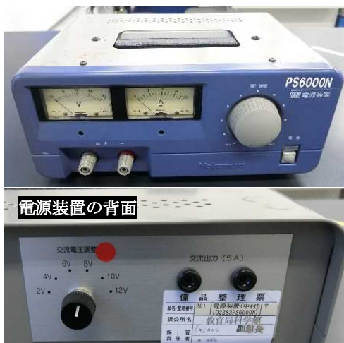
図3 実験に用いた電源装置
