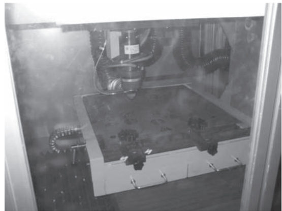
図6 レーザーカッターによる切り出し
