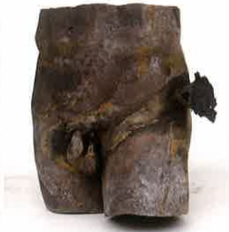
図 179 B 像左脚付け根の鋳掛け完成 (斜め前方)
