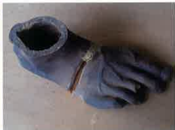
図139 A像右足甲 带状のパーツのデモ (ブロンズ+中子土+「油脂+蠟」の盛りつけ)
