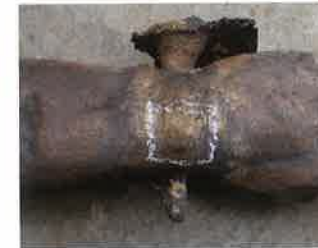
図 189 B 像左手の鋳掛け仕上げ前 (左側面)
