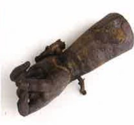
図 188 B 像左手の鋳掛け完成
