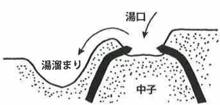
図82 ブツカケ鋳掛けの概略図
