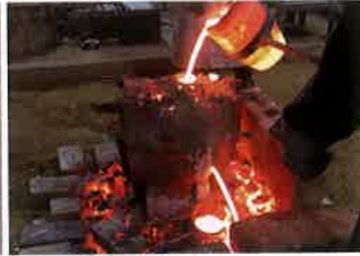
図 178 B 像左脚付け根の鋳込み
