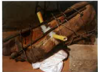
図 112 足裏部分のブリッジと脱湯口 (紙パイプ/黄色部分)
