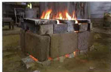
図 120 脱蠟鋳成中の窯
