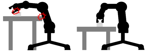
図4 垂直多関節ロボットは設置位置によって、作業平面に対する作業可能領域が変化する。
