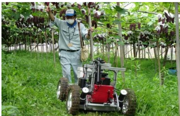
写真4 除草ロボットを使った草刈り作業の様子
