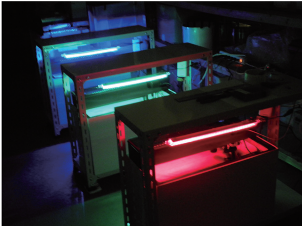
写真1 LED照明された3基の実験水槽
