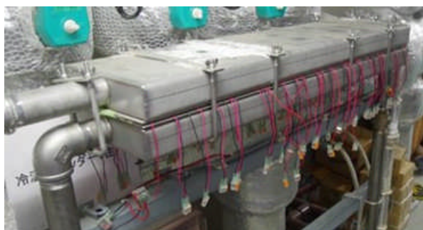
図6 ペルチェ素子を使用した実証実験装置（実物）
