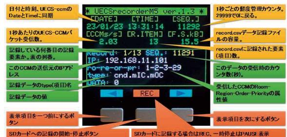
図 2 UECSrecorderM5 の表示内容とボタン機能の概略
