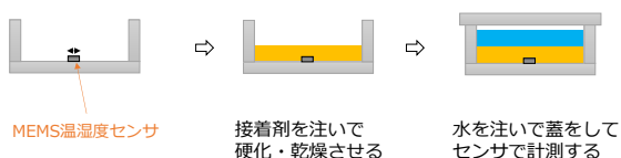
図2 測定セルの概略図
