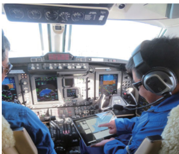
図5 パイロットの EFB (Electronic Flight Bag) 利用イメージ画面は SWIM 用情報。(写真は安全のため地上停機時に撮影。)
