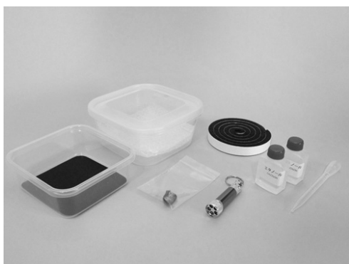
図2 ウィルソン桐箱実験キット (オキドキサイエンス社製)
