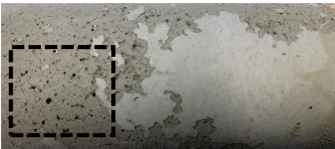
写真-1 硬化後に表面のセメントペーストを剥がすと直下に隠れ気泡が見えた
