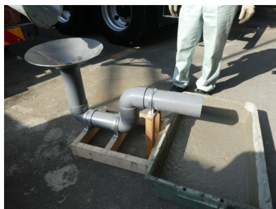
図-3 不合格品を検知（停止）する曲管
