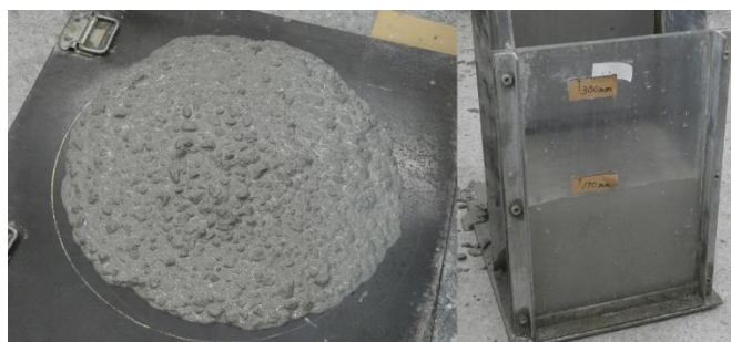
図-3 分離抵抗性に劣るコンクリートのサンプル試験結果：平均スランプフロー値 605 mm；粗骨材がフロー中心部に多く残り（左），ボックス試験上昇高さ（ランク 2：鉄筋 3 本）170mm に留まった（右）
