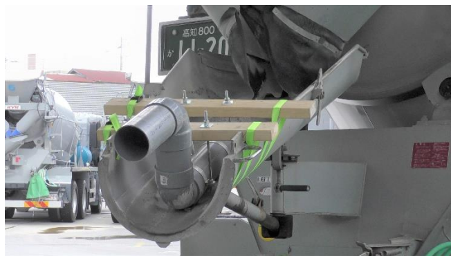
図-2 シュートに沿って下端に取り付けた鉛直曲管：コンクリートは常時試験器に流入するが、量的にはほとんどが試験器を経由せずにポンプ車に投入
