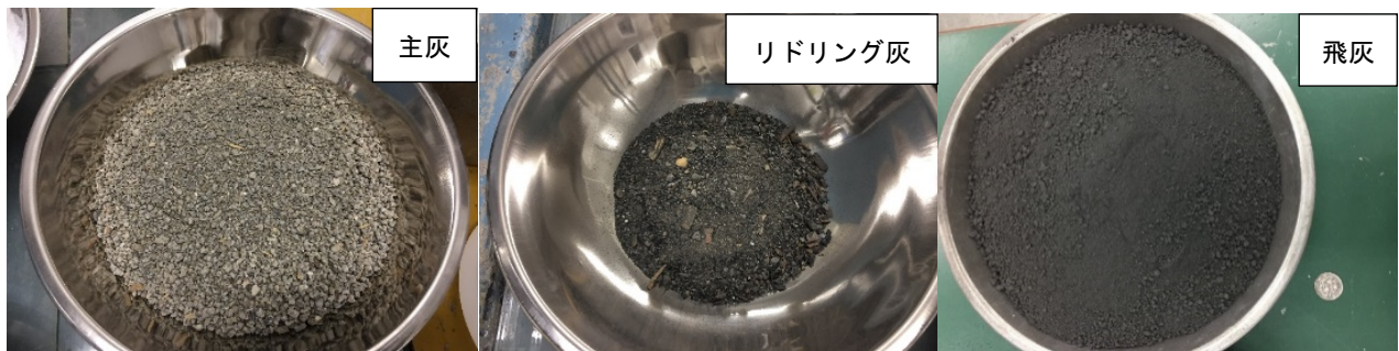
写真-1 3種類の木灰写真(現在では主灰とリドリング灰は産出後、混合して回収されている)
