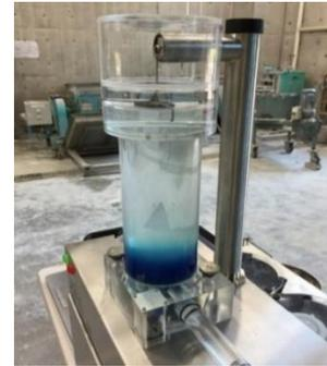
写真-1 自動気泡径測定装置(Air Void Analyzer)
