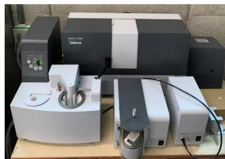
写真-2 レーザー回折式粒度分布測定装置
