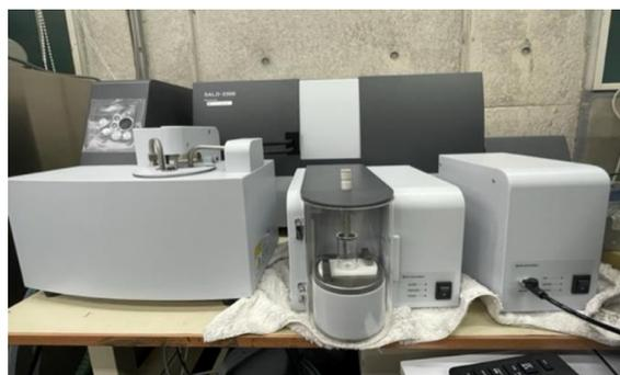
図-10 レーザー回折式粒度分布測定装置 (SALD)
