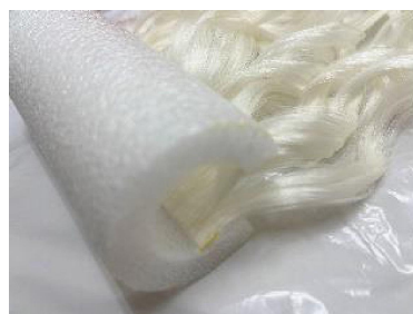
図8 カプセルに人工毛を接着
