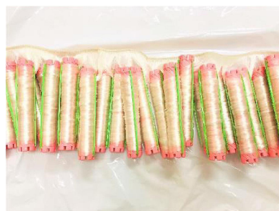
図6 人工毛にワインディングを施した状態
