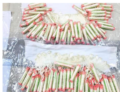
図7 ワインディング後の人工毛を型に接着した状態
