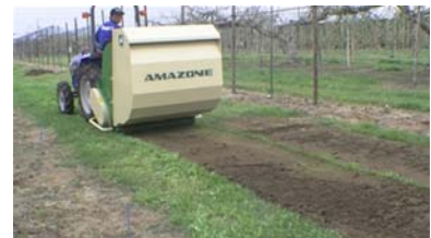
図 34 芝剥ぎ・回収一体機 (C方式)
