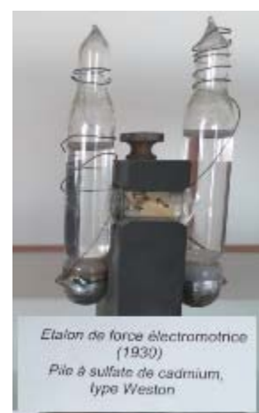
図 1. 1930年代の標準電池（硫酸カドミウム型）
