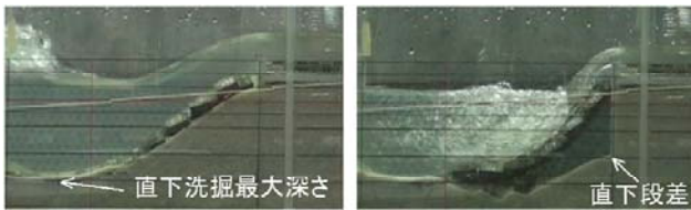
Fig. 6 減水による連結護床の吊り橋化 (左: 減水前, 右: 減水後 2 時間。「底板&連結護床」)
