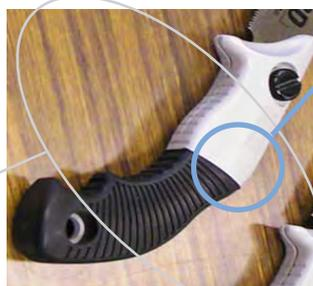
\* インサート成型: 金型内に芯材となる部品を装填した後、芯材の周囲に熔融樹脂を注入して固化させ、一体化した複合部品を作る工法
