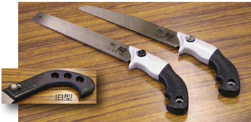
〇〇〇〇工業(株)は水道管切断鋸の専門メーカーである。同社の鋸把持部は替え刃の着脱時に、替え刃を固定する蝶ネジを把持部から分離する必要がないため、着脱時に蝶ネジを紛失することがなかった。また、着脱作業も容易であった。この点が他社製にない特徴であった。しかし、替え刃固定用の蝶ネジが切断作業の妨げになるとともに、全体的に華奢で握りにくかった。そこで、現行製品の着脱機構をベースに、作業性能を向上するグリップ開発を行った。
