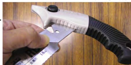
ネジを指で仮締めした後、コインでしっかり締める
