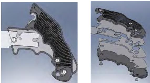
▲新たに考案した跳ね上げ式替刃着脱機構(左)とその部品構成(右)
