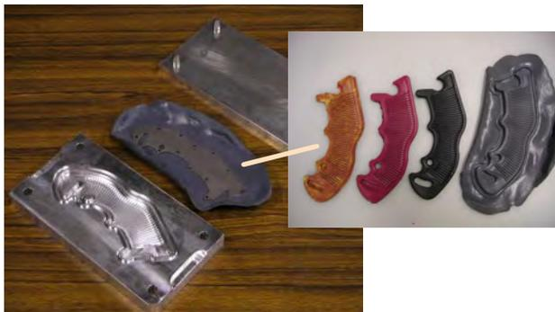
▲ステンレス芯材の片面のみをゴムで被うインサート成形(\*)方式を考案
