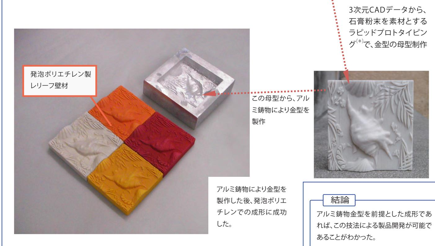
\*ラピッドプロトタイプング:金型なしにCADデータから、直接モデルを紙や樹脂を積層して製作する成形方法
