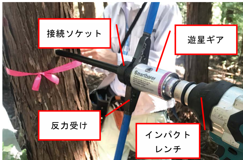
図2 スマートボーラーの構成部品 スマートボーラーは、遊星ギア、反力受け、接続ソケットから構成され、これらが市販されています。
