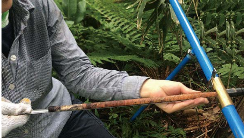
図1 成長錐によるコア試料採取 従来はハンドル（青色の棒）を人力で回すことにより、樹幹に成長錐ビットをねじ込んでコア試料が採取されてきました。
