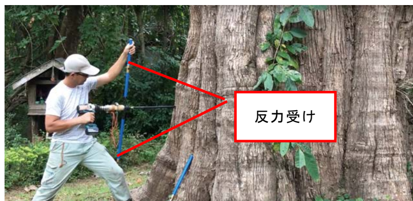
図3 スマートボーラーの使用風景 最大1mの長さのコア試料を大径材から採取することが可能です。
