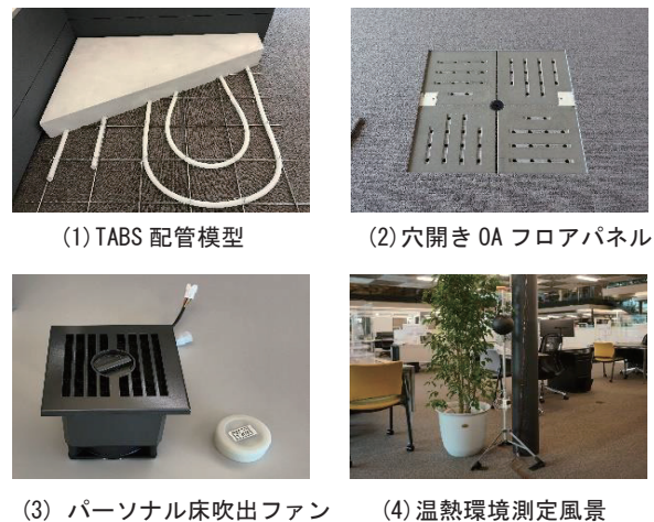
写真 2 躯体蓄熱放射・床吹出し空調及び温熱環境実測関係
