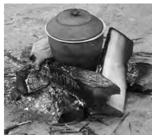
図3 直置き加熱実験における井桁状aと放射状bの薪配置
