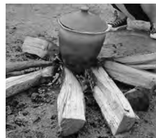
図3 直置き加熱実験における井桁状aと放射状bの薪配置
