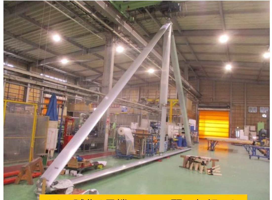
14m試作1号機の1つの翼の仮組みと 歪ゲージのキャリブレーション準備
