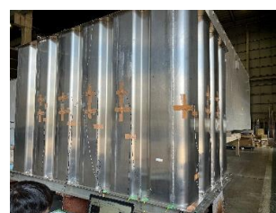
写真-2 ステンレス製一体型水槽
