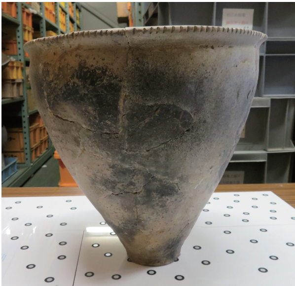
図2 HandySCAN BLACK™ | Elite での撮影風景。下に配置したターゲットシールからの反射を利用し、レーザーの光が遮られた位置を三角法で計算することにより、土器形状を計測する。計測しているのは kumomiya_187。撮影風景の動画は以下の URL も参照： https://researchmap.jp/read0143838/misc/35889195
