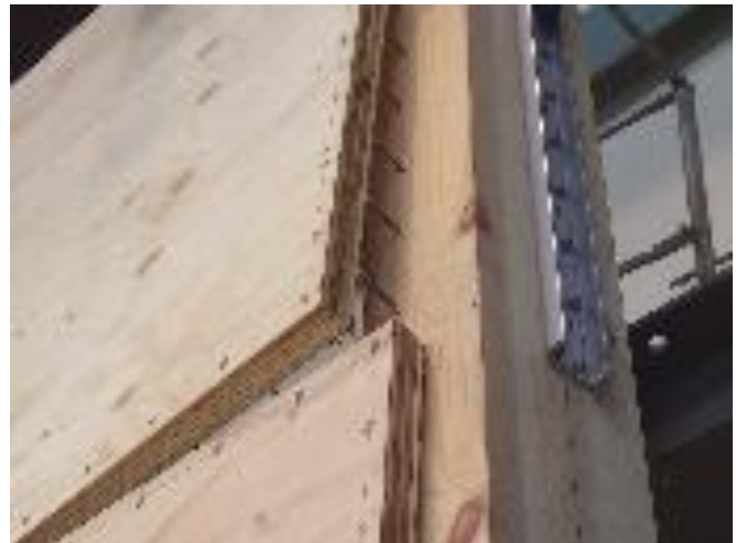
図4 梁に集成材を用いた場合の面材の浮き (G28-02) (-1/15 (rad)時)
