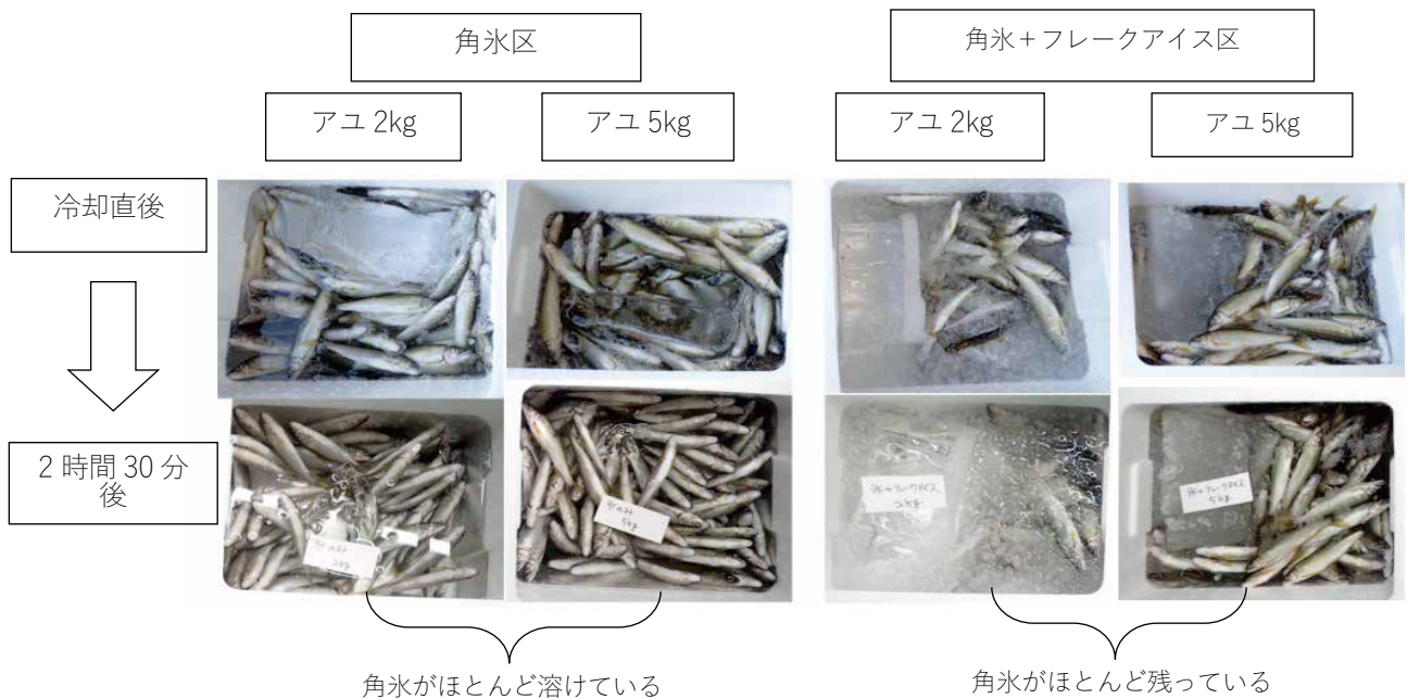
図 3. 試験区ごとのスチロール箱内の水温と角氷の状態 (0 日目 冷却直後と 2 時間 30 分後)
