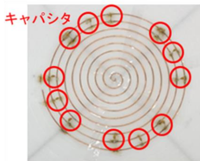
図 2 キャパシタを装荷した共振器
