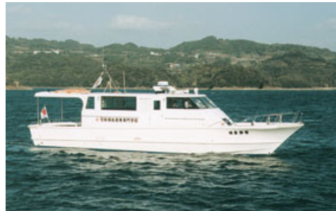
図 2. 実習船 はまかぜ (縦 14.64m, 横 3.8m, 高さ 4m)
