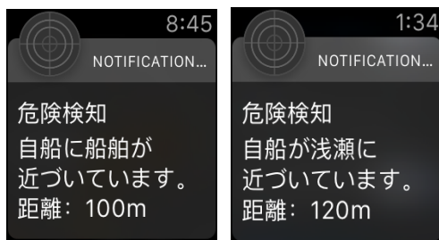
図 3 危険検知時における腕時計デバイスの画面 左：他船接近時 右：浅瀬接近時
