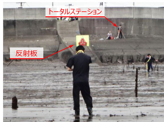
写真-1 測量機器を用いた干潟の地盤高計測
