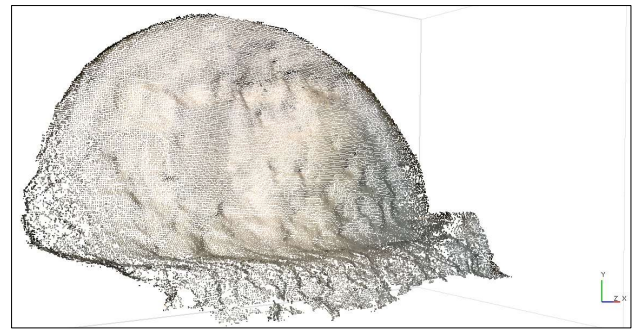
図-1 切羽面の高密度点群データの抽出結果
