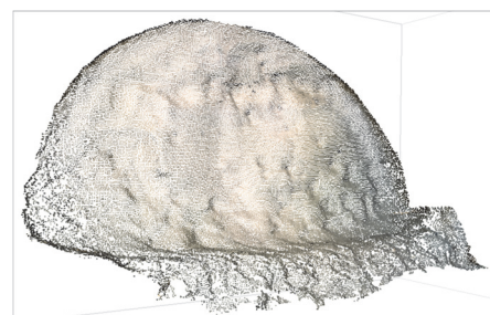
図-3 切羽面の高密度点群データの生成結果
