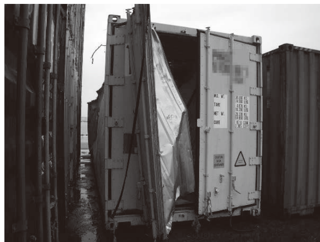
図表3 ふ頭から流出して損壊したコンテナ
