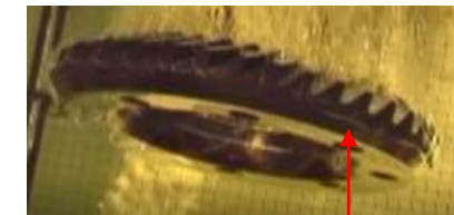
不安定な蒸気膜崩落起点
